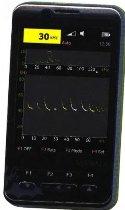
Auf dem Detektor werden Fledermausrufe als Spektr- und Sonogramm dargestellt. Jede Fledermausart hat eine typische Kennlinie, die zur Bestimmung der Art dient. Im Gerät ist dazu eine Datenbank hinterlegt.
